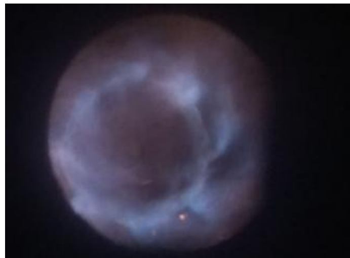
Chama IGR-HF em uma caldeira 30 ton/h com queimador UNNOx-G
